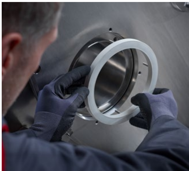
Sustitución sencilla de la junta sin necesidad de desmontar las tuberías instaladas de fábrica.
