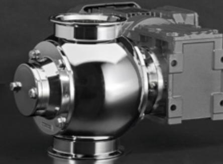
L'écluse rotative SAL est une écluse rotative de faible capacité dont la surface intérieure et extérieure est hautement polie. La SAL convient aux applications de dosage qui requièrent des normes d'hygiène très strictes, ainsi qu'une facilité d'utilisation et de nettoyage. L'écluse rotative complète peut être démontée pour inspection et nettoyée en quelques minutes, ce qui réduit les temps d'arrêt et les pertes de production.
